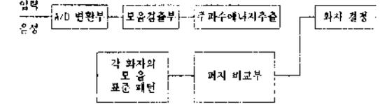
그림 4.1 화자인식 시스템
