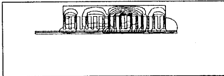
그림 3. 해석모델의 자속분포도 Fig 3. Flux lines of the model
