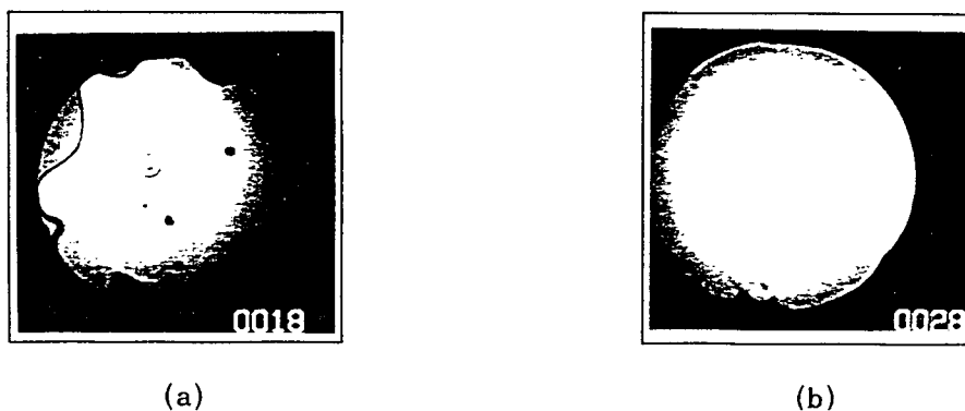
그림 1. IR Topogrphy System으로 살펴본 열처리 전후의 접합 웨이퍼 계면 상태 (a) 열처리 전 (b) 1000^\circ C 열처리 후
