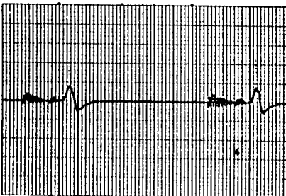
그림 7. 30kg·m/sec 부하용수철로 60 RPM에서 key를 넣은 상태 (CCW인 경우)
