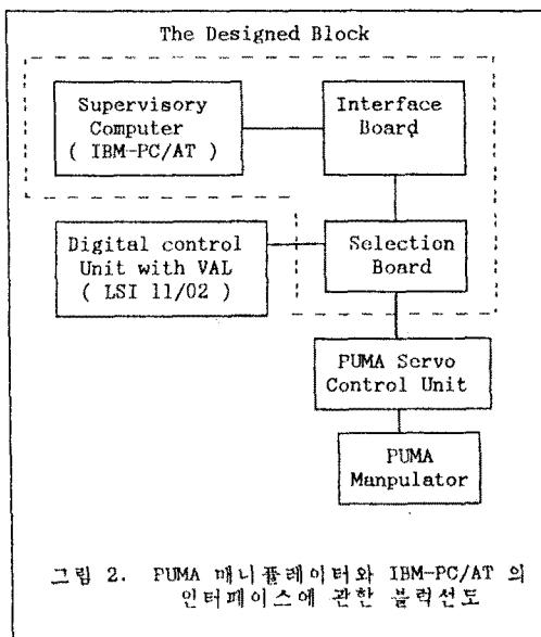
그림 2. PUMA 매니퓰레이터와 IBM-PC/AT의 인터페이스에 관한 블럭선도
