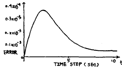
그림2. 모델과 프랜트의 상태섭동 벡터 Fig.2 reactor Power Perturbation of Model and Nuclear Reactor
